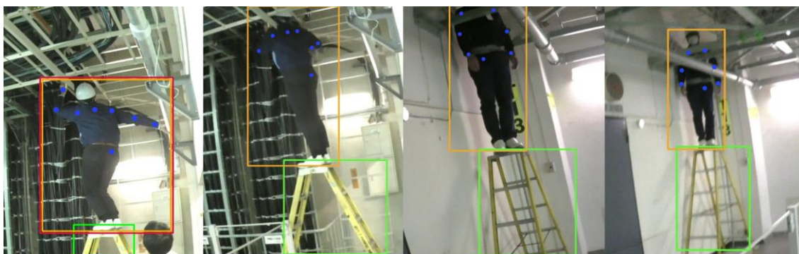
(図 3) AI が人間の骨格情報や脚立の位置を検知する様子
